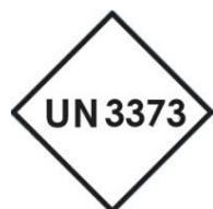
Für die Beförderung ist das abgebildete Kennzeichen auf der Außenverpackung vor einem kontrastierenden Hintergrund anzubringen – es muss deutlich sichtbar und lesbar sein (Breite der Linie = mind. 2mm, Buchstaben-/Zeichenhöhe mind. 6mm).
